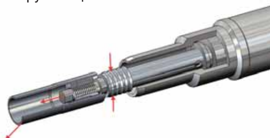
5. Сбрасывание извлеченного отрезка трубы с цанги
