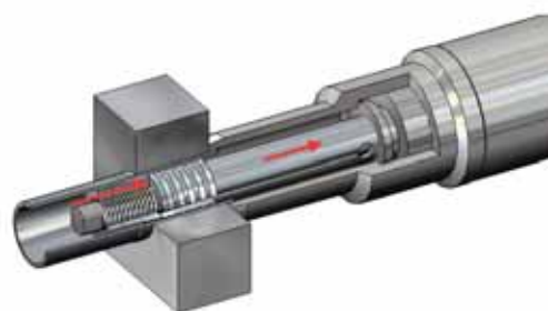
5. Сбрасывание извлеченного отрезка трубы с цанги
