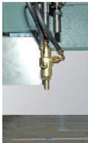
Принтерная головка и датчик края листа
