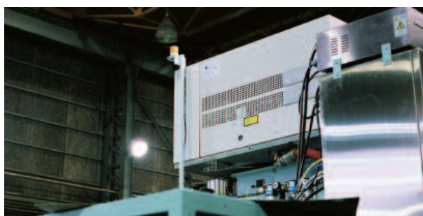
Лазерный резонатор, установленный на машине
