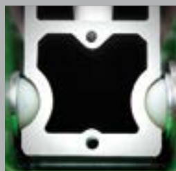
BST 352 V: установленная каретка на 4 специальных шариках
