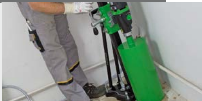
BST 182 V/S: установленная каретка на 4 специальных шариках
