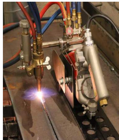
Прямой рез с рельсом ИК-93
