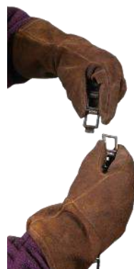
Звенья цепи можно отрегулировать по диаметру труб.
