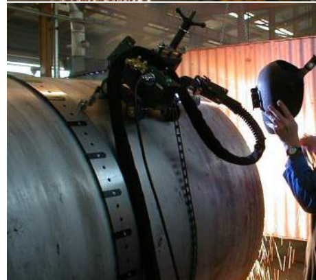
Направляющий рельс и специальный держатель горелки
