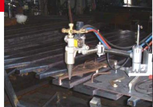
IK-82 M300 используется для резки профиля
