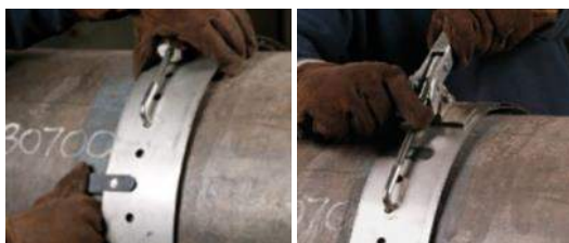
Система направляющего рельса быстрой фиксации
