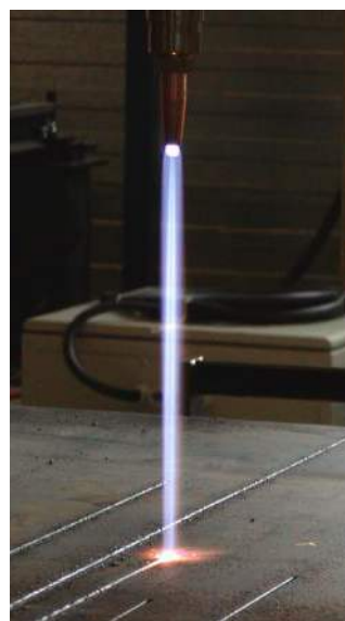
Сильный поток кислородной резки из дивергентного сопла: Фото взято из Koike тестирования. Тип сопла 106-D7#0. Над листом от сопла 275мм
