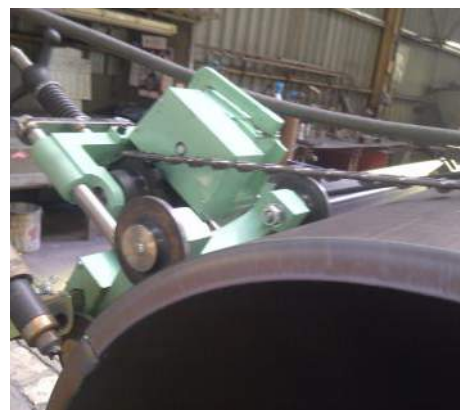
Направляющий рельс и специальный держатель горелки
