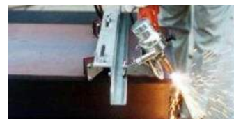
Прямая направляющая рельса 500 мм
